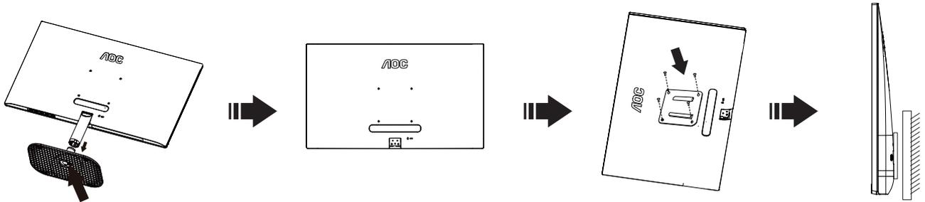
本顯示器可安裝於另購的壁掛支架。安裝前請先拔下電源線。按下列步驟進行：
