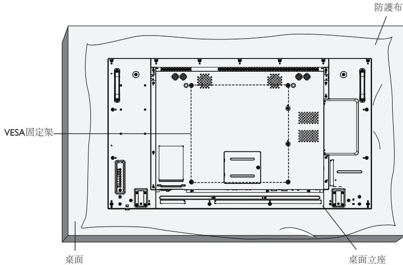
1. 將包裝時包覆顯示器的防護布鋪在桌面上，將螢幕朝下擺放防護布上，以免刮傷螢幕表面。
